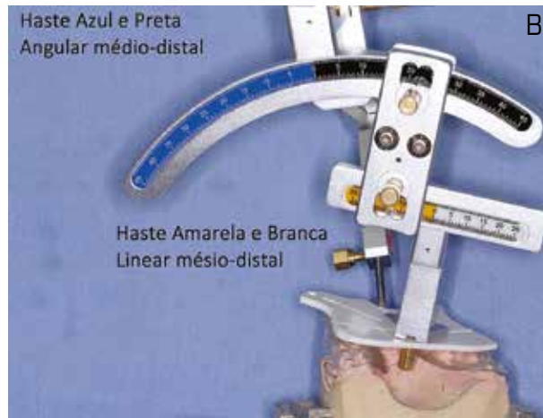
Figuras 7 A. Dispositivo DPT: haste vermelha, onde foi registrado o movimento linear vestibulolingual (VL); haste verde, onde foi registrado o movimento angular (VL); haste laranja, onde foi registrado o movimento linear cervico-apical (CA). B. Dispositivo DPT: hastes azul e preta, onde foi registrado o movimento angular mesiodistal (MD); dispositivo DPT: haste amarela e branca, onde foi registrado o movimento linear (MD). C. Posição onde a haste do DPT foi fixada no guia tomográfico.
